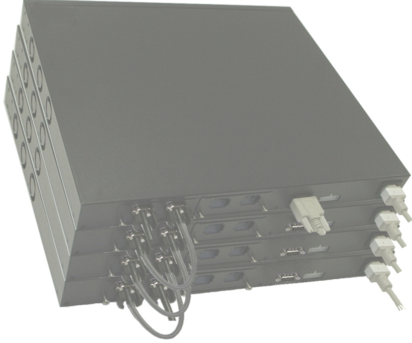
Şekil 1-3. Bir Anahtar Kumesinin Balanması
